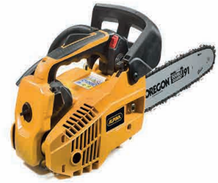
MOTOSIERRA ALPINA GASOLINA A305 10" 26cc Cilindrada: 25,4 cc. Tipo de cadena: 3/8 050"(91VG - 40E) Peso: 2,70 kg.
